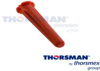
**TAQUETE THORQUETE THORSMAN TP2X 1/4 1103-14000 COLOR ROJO BOLSA 1000PIEZAELABORADO CON POLIETILENO DE ALTA DENSIDAD FLEXIBLE RESISTENTE AL IMPACTO Y EXTRACCIÓN SE RECOMIENDA TORNILLO 10 X 1 1/2 38MM**
