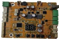
**Tarjeta electronica principla para torniquete tripode DS-K3G501LX DS-K3M107-G501LX
