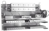
**Multiacoplador-Doble Preselector 300-512 MHz 25-32 Canales N/N 3-4 MHz 115 Vca / 13.6 Vcc. 25132-0/DH5**
