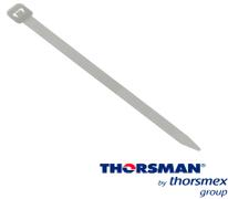
**CINCHO NYLON TH-100 THORSMAN 4200-01000 COLOR NATURAL A 25MM- L 100MM BOLSA/100PZS DIAMETRO MAXIMO CAPACIDAD DE ATADO 22mm FABRICADO EN POLIAMIDA Nylon 66 GRADO DE FLAMABILIDAD UL 94 V-2 TENSION 8 KG IDEAL PARA DUCTOS Y CABLES**
