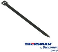
**CINCHO NYLON TH-100 THORSMAN 4200-01001 COLOR NEGRO A 25MM- L 100MM BOLSA/100PZS DIAMETRO MAXIMO CAPACIDAD DE ATADO 22mm FABRICADO EN POLIAMIDA Nylon 66 GRADO DE FLAMABILIDAD UL 94 V-2 RESISTENTE A LA CORROSIÓN HUMEDAD Y CLIMAS EXTREMOS TENSIÓN 8 KG IDEAL PARA DUCTOS Y CABLES**
