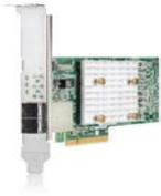
**TARJETA CONTROLADORA HPE SMART ARRAY E208E-P SR GEN10 2 PUERTOS EXTERNOS 12G SAS PCIE 804398-B21**
