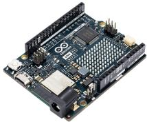
**ARDUINO UNO REV4 WIFI Retrocompatible con la UNO R3 la Arduino UNO R4 WiFi incluye una matriz LED 12x8 para interfaz mejorada y destaca por su conectividad y mayor potencia de procesamiento ABX-00087**
