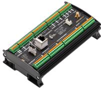
**PORTENTA MACHINE CONTROL** Ideal para aplicaciones en la **Industria 4.0** gracias a sus múltiples puertos de comunicación y una programación flexible en estándares de PLC o Arduino IDE AKX-00032
