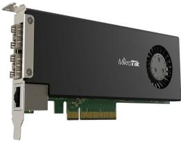
**CCR2004-1G-2XS-PCIe, Ruteador CCR en tarjeta NIC PCIe, CPU 1500 MHz, 4 GB de RAM, 1xGigaEth, 2xSFP28 de 25G, RouterOS Nivel 6**
