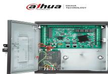
**DAHUA ASC2204C-H - Control de acceso TCP/IP avanzado que gestiona 4 puertas con 4 lectoras vía Wiegand o RS485 soporta hasta 200000 tarjetas 150000 eventos y es compatible con biométricos DHI-ASC2204C-H**
