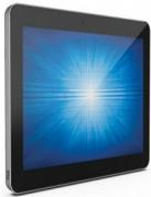
**Elo I-Series 3.0 - Todo en uno - 1 x Snapdragon APQ8053 hasta - RAM 3 GB - SSD 32 GB - eMMC 5.1 - Gigabit Ethernet - 802.11a/b/g/n/ac Bluetooth 4.1 - Android 8.1 Oreo - monitor LED 10.1 1280 x 800 WXGA pantalla táctil - negro**
