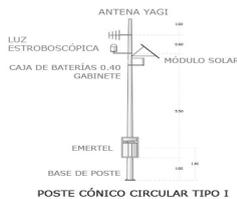
**Radioteléfono de emergencia en VHF incluye transceptor de 50 Watts Basado en radios KENWOOD Serie 302. EMERTEL-45V**
