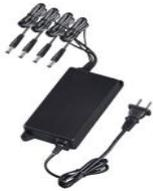
**FUENTE DE PODER/ DAHUA/ EUHA12120-070D PFM322/ REGULADA DE 12 VCC 2.8 AMPERES/ SALIDA TIPO PULPO DE 4 CANALES CON CONECTOR MACHO/ 0.7 AMPER POR CANAL/ PROTECCION DE TEMPERATURA/ COLOR NEGRO EUHA+12120-070D**
