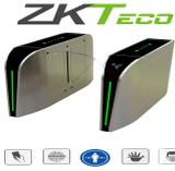
**ZKTECO FBL300 - Barrera Peatonal Tipo Flap Bidirecc / 2 Chasis Acero SUS304// Aleta de Acrílico/ 110V/ 35 Personas x Min/ Carril 60 cm/ Exterior Protegido/ 2 millones de Ciclos/ 5 pares de Infrarrojos / No cuenta con Lectores y Panel FBL300**
