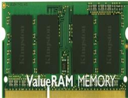
**Kingston ValueRAM - DDR3 - módulo - 8 GB - SO DIMM de 204 contactos - 1333 MHz / PC3-10600 - CL9 - 1.5 V - sin búfer - no ECC**
