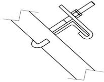
**Herraje para sujeción de escalerilla y guía de cable en cara de torre SSV para secciones 6N a 11N KY-695**
