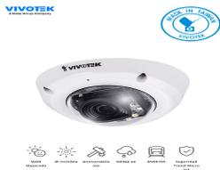
**VIVOTEK MD8565N - Cámara IP domo exterior 2 Megapíxeles/ Lente Fijo 2.4mm/ Micrófono Integrado/Protección IP66 IK10 Nema4X/ Smart IR Invisible 10mts/ Smart Stream II/ Certificación EN50155/ Ciberseguridad Trend Micro/Dual Power PoE y DC/ONVIF MD8565-N**
