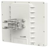
**QRT 5 Punto de Acceso hasta 300 Mbps en 5 GHz 4.9 - 5.875 Antena Integrada 24 dBi Hasta 1000 mW de Potencia RB911G-5HPND-QRT**
