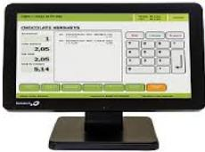
**Logic Controls SB1015AW - Todo en uno - 1 x Cortex-A9 16 GHz - RAM 1 GB - flash - eMMC 8 GB - WLAN 80211a/b/g/n Bluetooth 40 - Android 444 KitKat - monitor LCD 156 1366 x 768 WXGA pantalla táctil**
