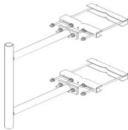
**Montaje Lateral con 60 cm de Separación con Ángulo Ajustable. Mástil de 2-3/8 x 36. TRY-ST-LME-2A**
