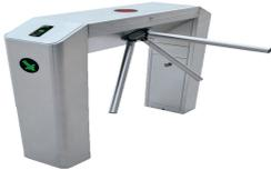
**ZKTECO TS2022PRO - Torniquete Bidireccional Semiautomático Tipo puente / Acero SUS304 / Carril 50 cm / 110V / Exterior Protegido / 25 a 48 Personas x Min. / Indicadores LED / Incluye Lectores FR1200 y Panel InBio260 Integrado spf TS2022 with InBio260PRO**
