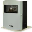
**PANEL DE INCENDIO INTELIGENTE KIDDE VS1-G-SP CUENTA CON UN LAZO DE DISPOSITIVOS INTELIGENTES CLASE A O CLASE B QUE ADMITE HASTA 64 DISPOSITIVOS DIRECCIONABLES DETECTORES O MODULOS CUENTA CON DOS CIRCUITOS PARA DISPOSITIVOS DE NOTIFICACIÓN DE CLASE B NAC.**
